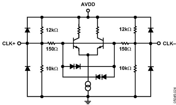
Figure 24. Clock Inputs
