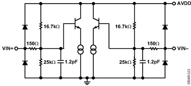
Figure 23. Analog Inputs
